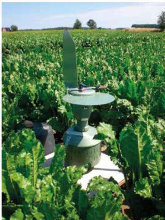
Foto 1 og 2. Burkard sporefælde opstillet i markforsøgene. Ved hjælp af en vacuumpumpe indsuges luft i hastighed 10 liter pr min. Luften med partikler af jord, pollen, svampesporer og lign. passerer et stykke tape, hvortil partiklerne klæbes. I laboratoriet bliver tapestrimlen klippet op på dagsbasis, og herfra kan DNA ekstraheres og qPCR udføres.
