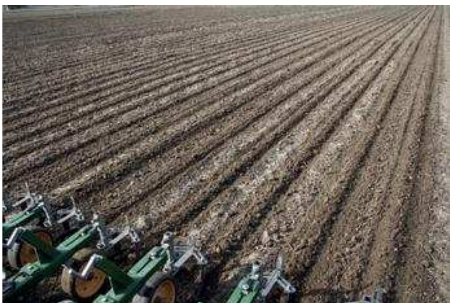
Foto 6. Færdigt såbed i opløjet jord. Da kun cirka halvdelen af jorden bearbejdes og hvert rækkemodul præcist følger jordoverfladen, vil det være muligt at anvende store maskinbredder, f.eks. 24 rækker (12 m). Bemærk at jorden mellem rækkerne er fuldstændigt urørt, hvilket forventes at reducere fremspiring af ukrudt (se Sukkerroe-Nyt, december 2011).
