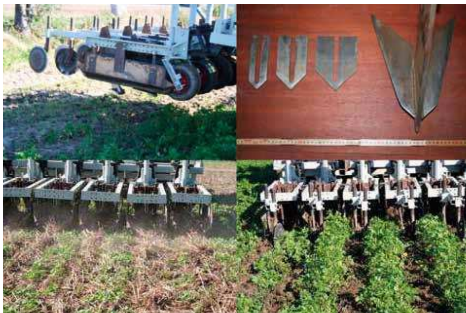
Fotos 3. Til at anlægge striberne blev der anvendt en specialfremstillet projektharve, hvorpå der nemt kunne monteres forskellige typer af tænder. Det meste arbejde blev lavet med de viste tænder (øverst til venstre), hvorpå der kunne monteres vinger med forskellige dimensioner (øverst t.h.). De bedste resultater blev opnået med to overkørsler. Ved den første overkørsel (aug.) bearbejdes så overligt som muligt med henblik på at fjerne efterafgrøder, spildkorn og ukrudt i striberne. Ved den anden overkørsel (sept.) bearbejdes i indtil 20 cm dybde.
