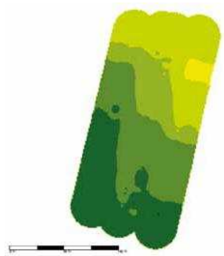
Figur 3. Markkort af biomasse i roemark genereret af Yara N-sensor. I øverste højre hjørne af marken var der problemer med rodbland og derfor mindre biomasse.
