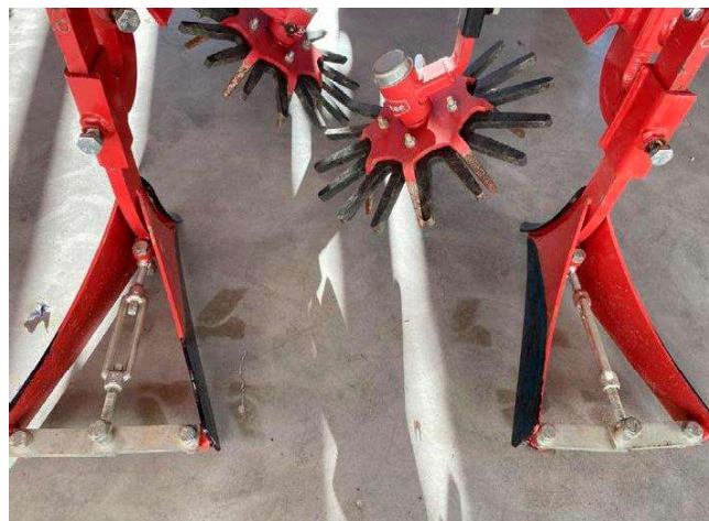
Foto 2. I GUDP-projekt blev metoder til hypning af sukkerroer sammenlignet. Den simpleste metode bestod af to metalplader monteret skråtstillet på strigletand (t.v.). En mere avanceret variant består af en kombination af fingerrensere og hyppeløve, som her er monteret på en Steketee-radrenser.
