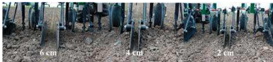
Billedet viser radrenserens indstilling i de forskellige led. Indstillingerne var 2, 4 og 6 cm fra rækken, dvs. at sidepladernes afstand imellem hinanden var 4, 8 og 12 cm.
