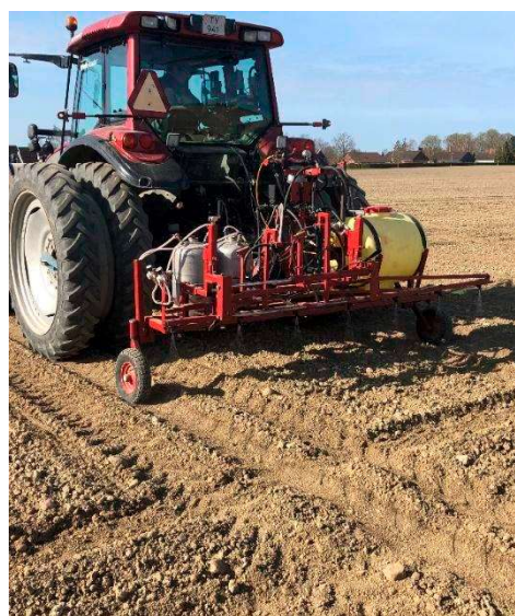
Billede 2. Båndsprøjte til forsøgssprøjtning.
