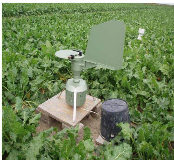
Foto 1. Burkard sporefælde ved forsøg. Der suges konstant luft ind, der passerer et stykke roterende tape, hvor svampesporer og andre partikler klæbes fast til.
