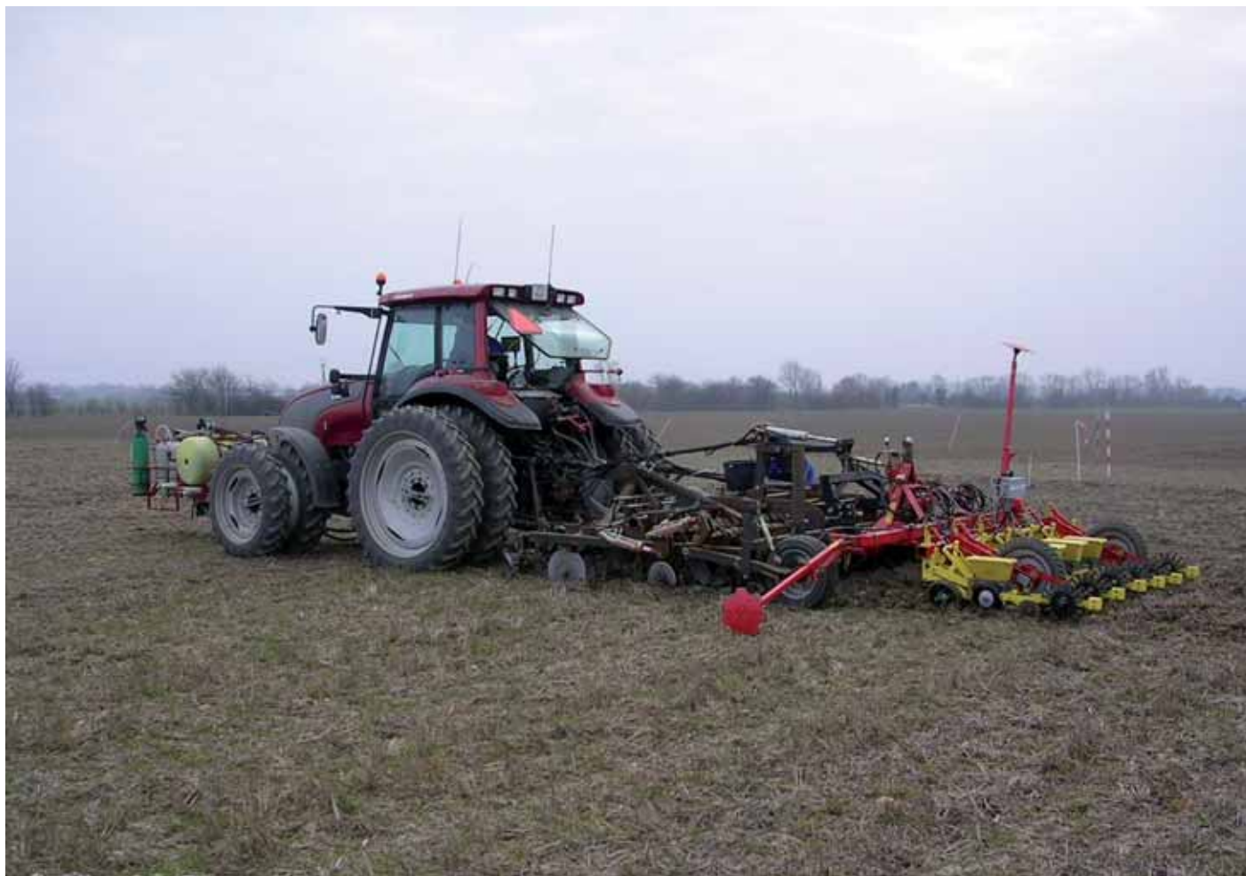
Placering af gødningen er foretaget i en arbejdsgang med ALCS-tanden under rækken i en mængde, samtidig med at den supplerende mængde placeres med rulleskær ved siden af rækken.
