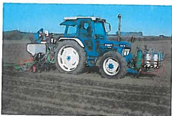
Nedfældning af flydende ammoniak udføres med denne 3 m nedfælder.
