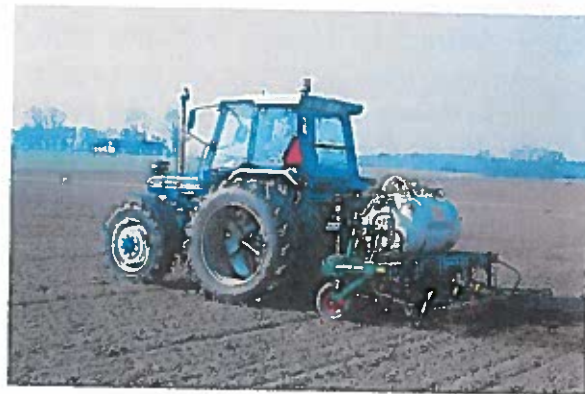
Nedfældning af flydende ammoniak udføres med denne 3 m nedfælder.
