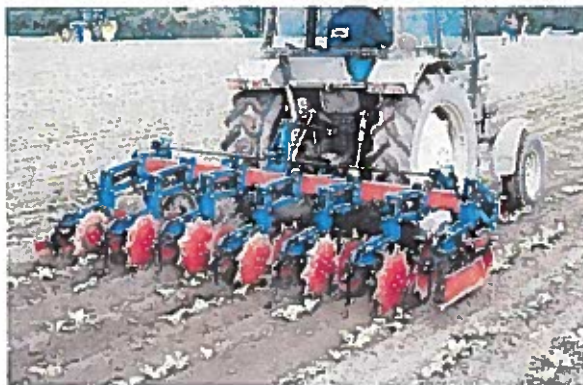
Fuldstændig mekanisk renholdelse af roemarken stiller store krav til rækkekultivatoren.
