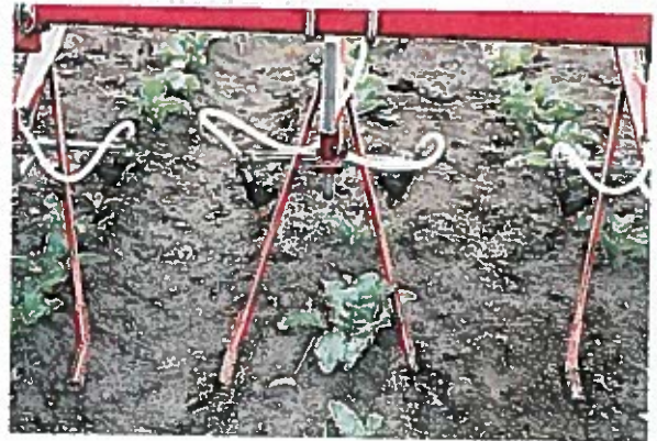
Ved sprøjtning af et 20 cm bånd er kemikalieforbruget 60 pct. mindre.
