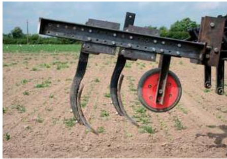
Billede 7. I det nuværende projekt tages udgangspunkt i en fleksibel parallelogramophængt ramme, hvor forskellige tænder kan afprøves. Billedet er fra den første testkørsel i maj 2008, hvor princippet med to tænder på række og i forskellig dybde blev testet. Rammerne til det seks-rækkede forsøgsredskab er fremstillet hos Møller Andersen ApS.
