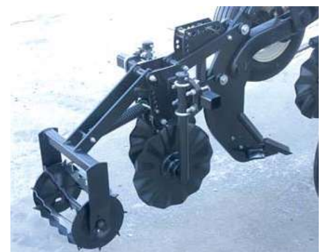
Billede 2. Rækkemodul til partiel bearbejdning fra amerikanske Unverferth. Fotoet er fra producentens hjemmeside.
