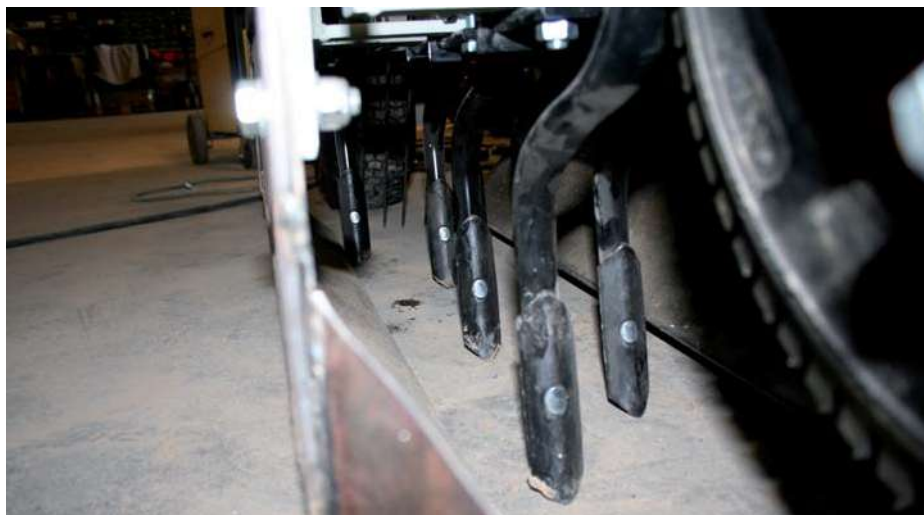
Billede 6. Der er syv harvetænder for hver række. Hver tand er tre cm bred og samlet bearbejdes således en 21 cm bred stribe. På sigt forventes det at antallet af tænder og arbejdsbredden kan reduceres, efterhånden som præcisionen øges gennem anvendelse af GPS.
