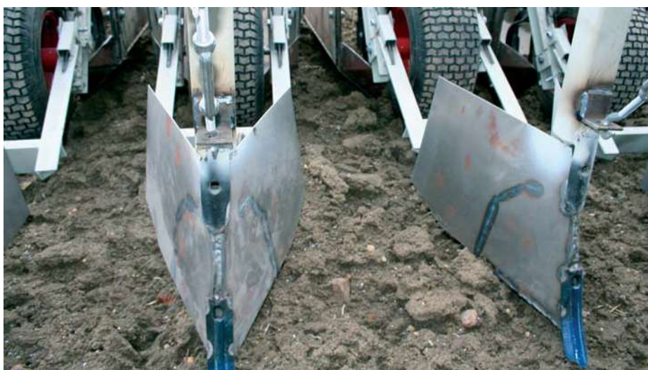
Billede 5. Til at fjerne væltede stængler af gul sennep er seks tidligere hyppelove blevet bygget om. Plovene er ophængt i parallelogram og dybden styres af et hjul (skjult bag pladerne). Harvetanden rører netop jordoverfladen og sikrer (forhåbentligt) at plantemateriale fjernes fra rækken.
