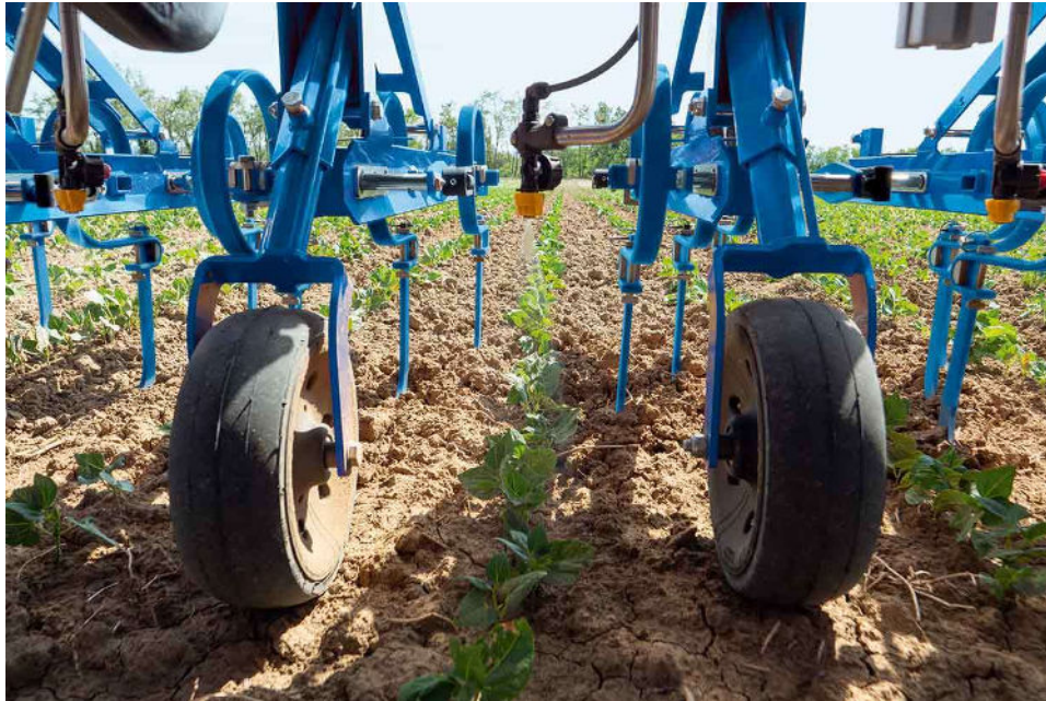
Foto 2. Rækkesprøjten i dette projekt består af en radrenser med påmonterede dyser over rækkerne. Der findes mange modeller på markedet – nogle er bare en meget simpel ramme med dyser. Der sprøjtes et forholdsvis bredt bånd over rækkerne, så præcisionen behøver ikke være meget høj – når blot man sikrer at der er overlap mellem det sprøjtede og det radrensede bånd.
