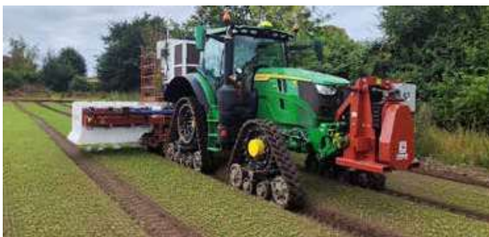
Carbon Robotics LaserWeeder. Ogräsen skjuts ihjäl med en laserstråle. Bilden är tagen i en spenatodling utanför Landskrona. Bilden på föregående sida visar resultatet.
