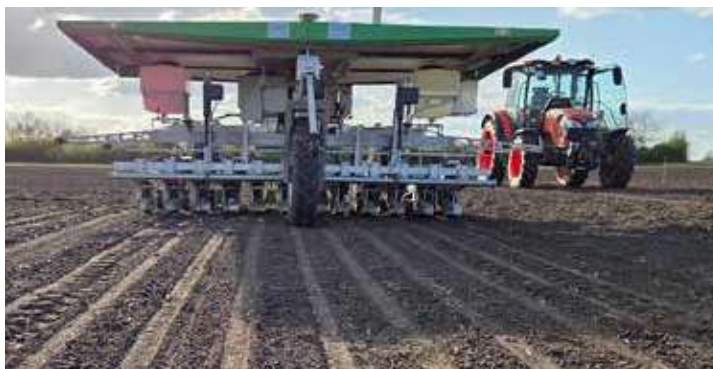
FarmDroid FD20 är den maskin som tydligast gått från pionjärfas till kommersiell användning i sockerbeter. Den kan börja rensa redan innan grödan syns.
