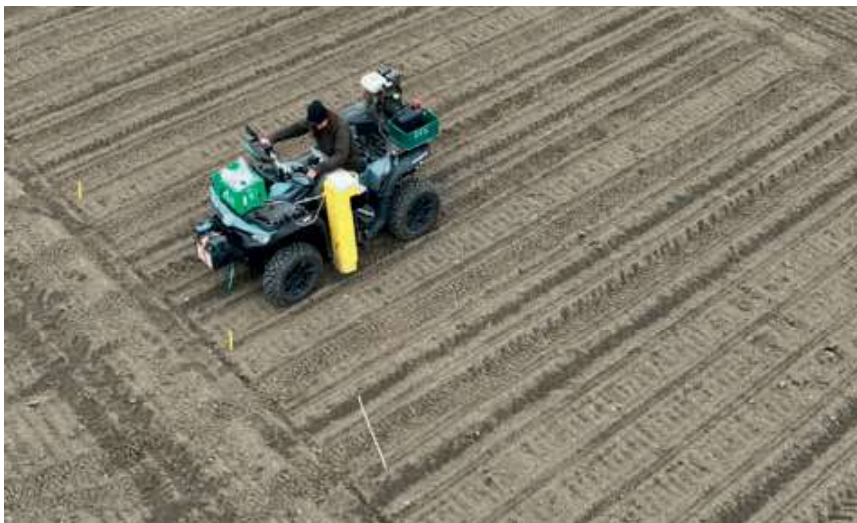
Foto 1: Prøvetagning i nematodeforsøgene, hvor der skal tages mange prøver, udføres med et mekanisk jordbor monteret på en ATV.
