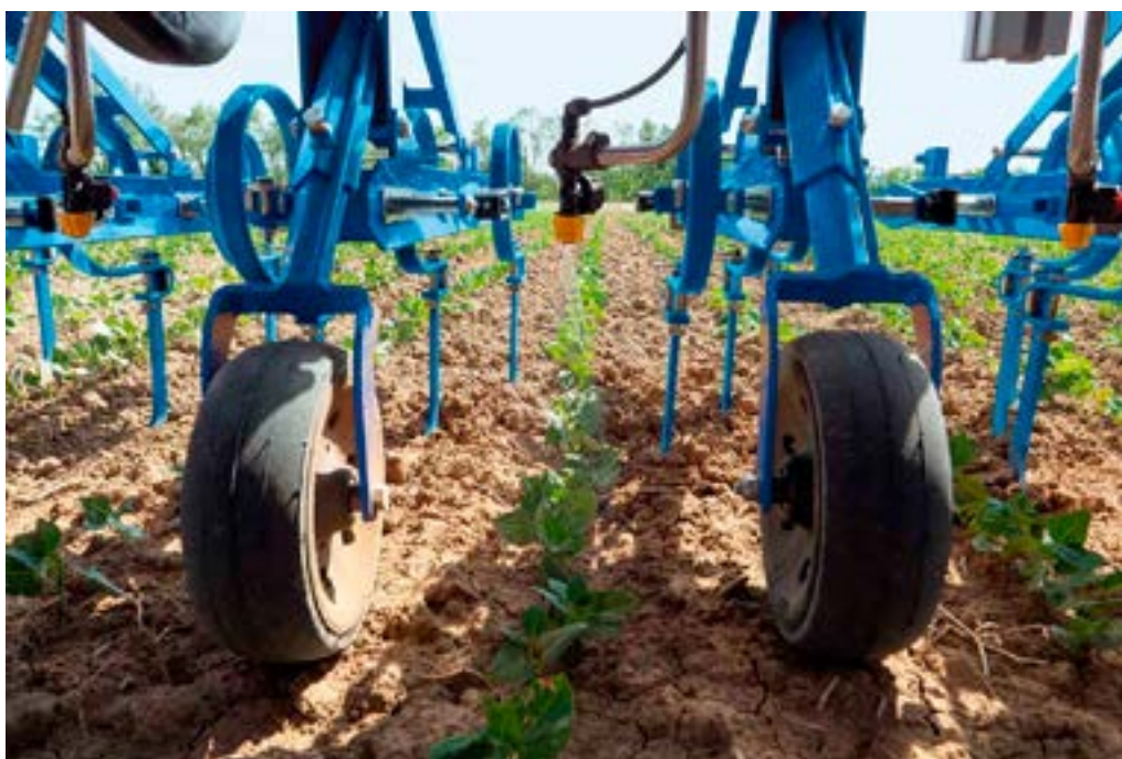
Foto 2. Rækkesprøjten i dette projekt består af en radrenser med påmonterede dyser over rækkerne. Der findes mange modeller på markedet – nogle er bare en meget simpel ramme med dyser. Der sprøjtes et forholdsvist bredt bånd over rækkerne, så præcisionen behøver ikke være meget høj – når blot man sikrer at der er overlap mellem det sprøjtede og det radrensede bånd.
