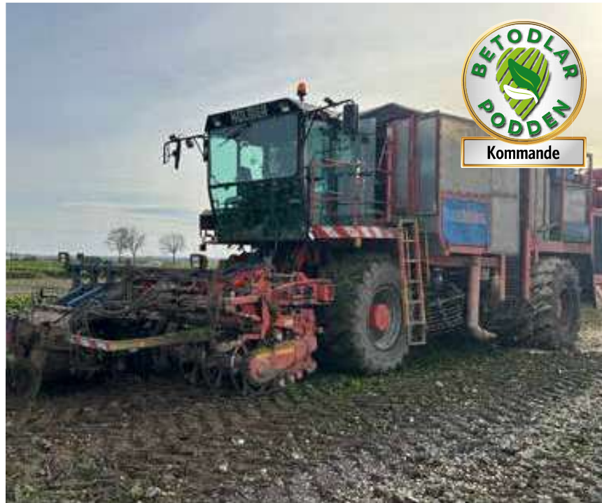
Försöksbetupptagare från tillverkaren Holmer. Upptagaren, som tar tre rader åt gången, är från 1997 och har byggts om så att den i stället för en bettank har ett inbyggt analyslaboratorium.
