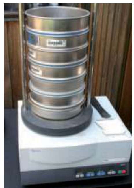
Billede 5. Rysteapparat til fraktionering af jordknoLde/jordaggregater. Jorden placeres i den øverste sigte og rystes i ca. 5 sekunder. Udstyret er venligst udlånt af Københavns Universitet.
