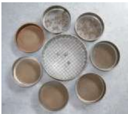
Billede 6. Der anvendtes sigter med maskestørrelser på 16, 8, 4, 2, 1, 1/2 og 1/4 mm til fraktionering af jorden.
