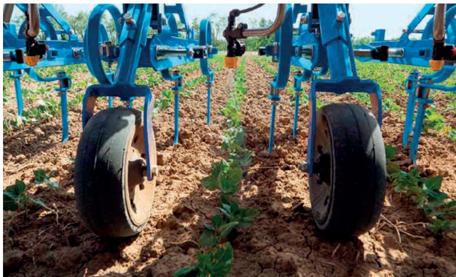
Billede 2. Rækkesprøjten i dette projekt består af en radrenser med påmonterede dyser over rækkerne. Der findes mange modeller på markedet – nogle er bare en meget simpel ramme med dyser. Der sprøjtes et forholdsvis bredt bånd over rækkerne, så præcisionen behøver ikke være meget høj – når blot man sikrer, at der er overlap mellem det sprøjtede og det radrensede bånd.
