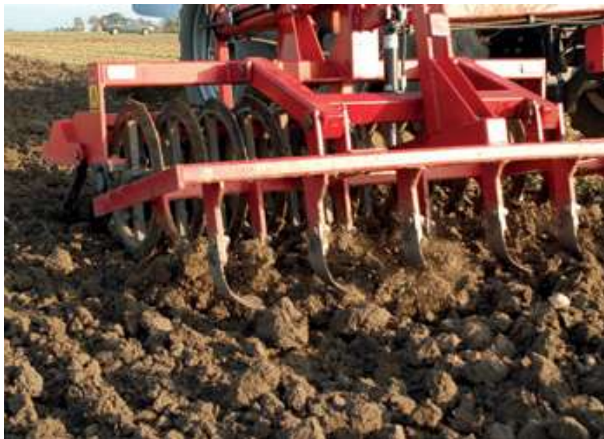
Foto 5. Albom II er frontmonteret og er konstrueret af Christian Wraghe med udgangspunkt i Albom I. Der er anvendt fræsertænder som harvetænder, og disse efterfølges af pakkevalse og slæbeplanke (Pløjboy). (Fotograf: Robert Olsson, NBR)
