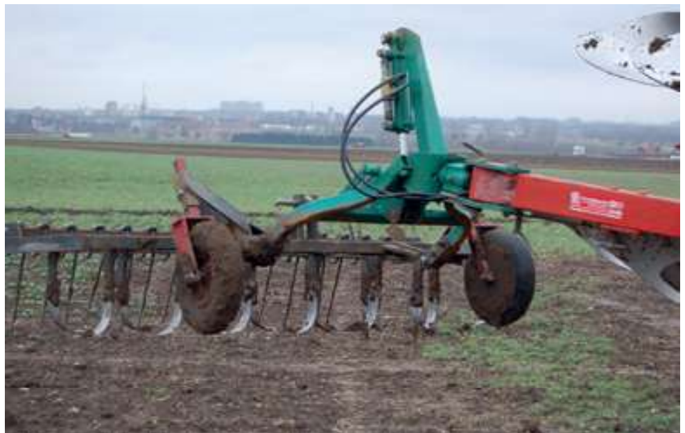
Foto 4. På Albom I anvendes fræserknive, som harvetænder. Disse er robuste og slidstærke nok til at jævne pløjejorden. Derudover er der bagerst én række kraftige efterharvetænder. (Fotograf: Robert Olsson, NBR)
