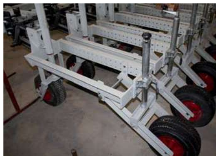
Billede 3. Hver enkelt ramme kan monteres med forskelligt udstyr ved at bolte det på. Dermed kan redskabet relativt nemt bygges om. Der er højdehjul forrest som standard, og derudover kan der for eksempel monteres højde-/pakkehjul bagerst.
