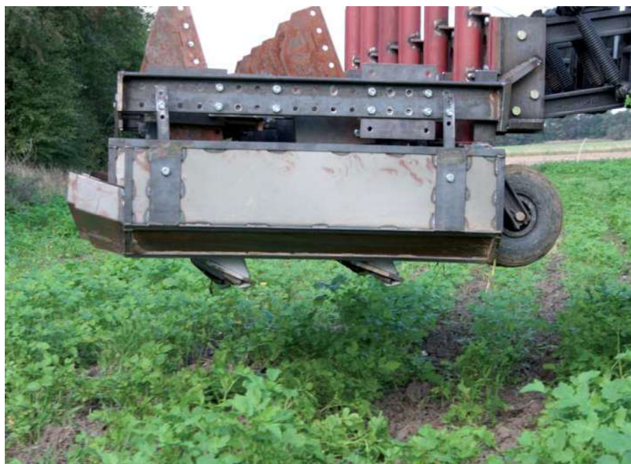
Billede 6. Eksempel på anvendelse af forsøgsredskabet. Der er monteret to kraftige tænder til at bearbejde jorden i indtil 20 cm. Skærmene holder jorden samlet omkring rækker og beskytter en eventuel efterafgrøde (billede 1).
