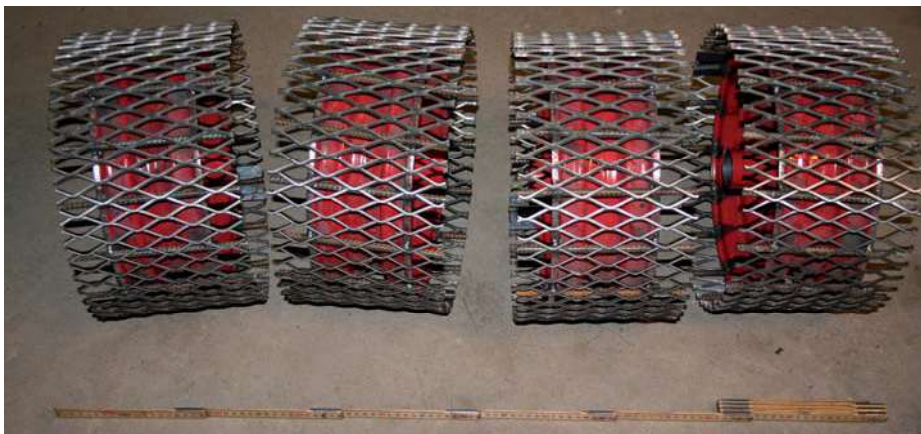
Billede 4. Gummipakkehjulene kan hurtigt erstattes med valser, hvis dette viser sig at være en bedre løsning.
