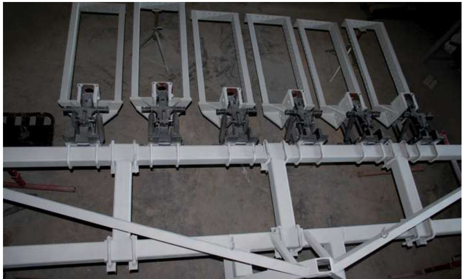
Billede 2. Forsøgsredskabet består af seks selvstændige moduler, der er koblet til en fælles ramme gennem et parallelogram.
