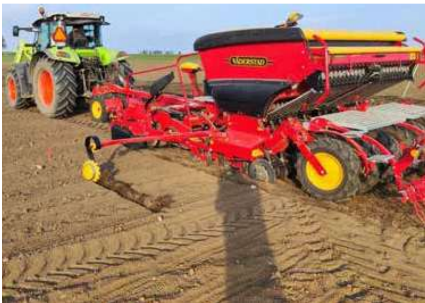
Djupmyllat med Rapid. Hela försöksytan bearbetades med Rapid för att få samma förutsättningar för alla led. Gödningen placerades på 8-10 cm djup med gödningsbillarna som öppnades i de led som skulle gödslas.
