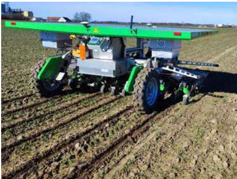
Den nya gödselplaceringen för Farmdroid kommer att testas våren 2026. Munstycket och ventilen, utvecklade på begäran av NBR, kan leverera 2 ml näringslösning till varje planta
