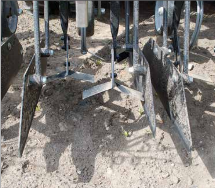
Radrensaren var utrustad med skyddsplåtar, dubbla L-skär vid sidorna och gäsfotskär i mitten. Från körningen vid 6-bladsstadiet även med "afterharv".
