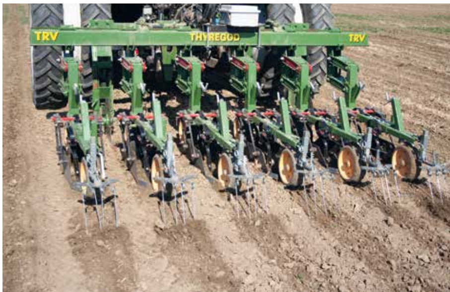
Foto 3. Thyregods TRV-radrenser er ombygget til rækkebaseret (strip-tillage) såbedsharve ved at montere et ekstra hjul bagerst samt ved at erstatte radrensertanden med tre såbedsharvetænder.
