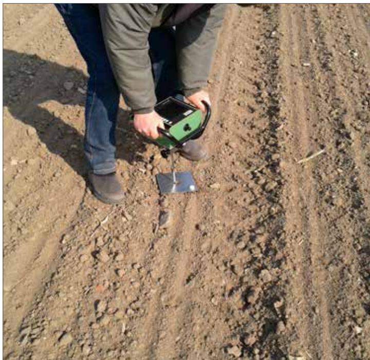
Bild 2. Med hjälp av en penetrometer mäts jordmotståndet i alla parceller.
