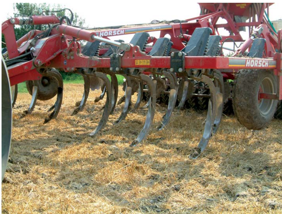
En Horsch Tiger blev anvendt til den kombinerede stubbearbejdning og efterafgrødesåning.
