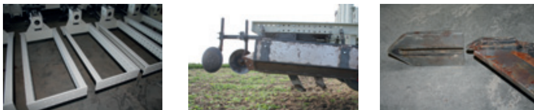
Foto 1-3. Forsøgsredskab til rækkeorienteret jordbearbejdning (strip tillage). Der er seks rækkemoduler (t.v.), hvorpå udstyr monteres (midt) til test af f.eks. tanddesign (t.h.)
