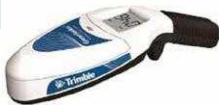
Figur 3. I projektet anvendes GreenSeeker til at måle roernes refleksion af lys (angives som vegetationsindekset NDVI).
