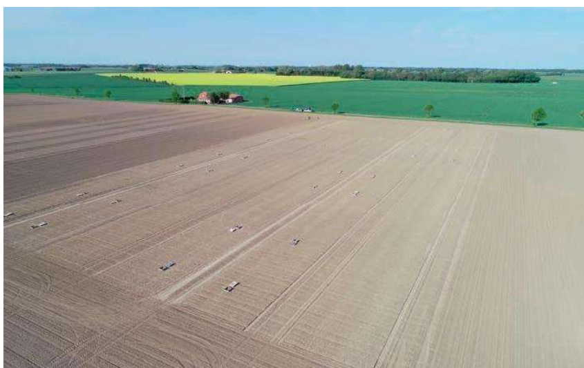
Foto 1. I udvalgte NBR-forsøg indgår lattergasmålinger. Denne udføres ved at opsætte kamre, hvorfra der udtages luftprøver til analyse for klimagasser. Målingerne udføres løbende i dyrkningssæsonen og især i perioder, når der forventes en øget risiko for lattergasdannelse. Ved hver måling udtages 2-4 luftprøver i løbet af en time. Rammerne (og de tilhørende kamre) er en del af NBR's samarbejde med SLU-Alnarp.
