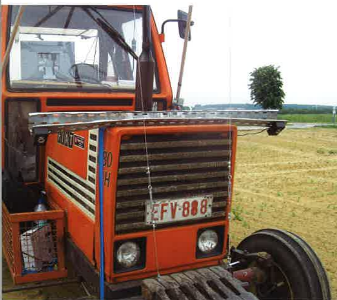
Bild 2 och 3. Med två enkla webbkameror framme på traktorn (bilden ovan) kopplade till ett bildbehandlingsprogram kunde man identifiera potatisplantorna. Färgat vatten över plantorna visade att utrustningen kunde slå till och från rätt munstycke vid rätt tidpunkt för att träffa potatisplantan med sprutvätska (bilden nedan).
