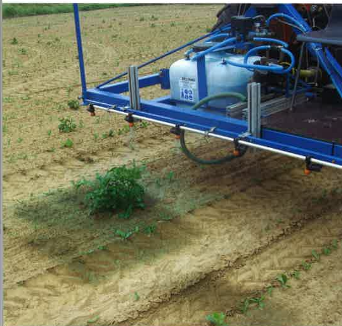
Bild 2 och 3. Med två enkla webbkameror framme på traktorn (bilden ovan) kopplade till ett bildbehandlingsprogram kunde man identifiera potatisplantorna. Färgat vatten över plantorna visade att utrustningen kunde slå till och från rätt munstycke vid rätt tidpunkt för att träffa potatisplantan med sprutvätska (bilden nedan).
