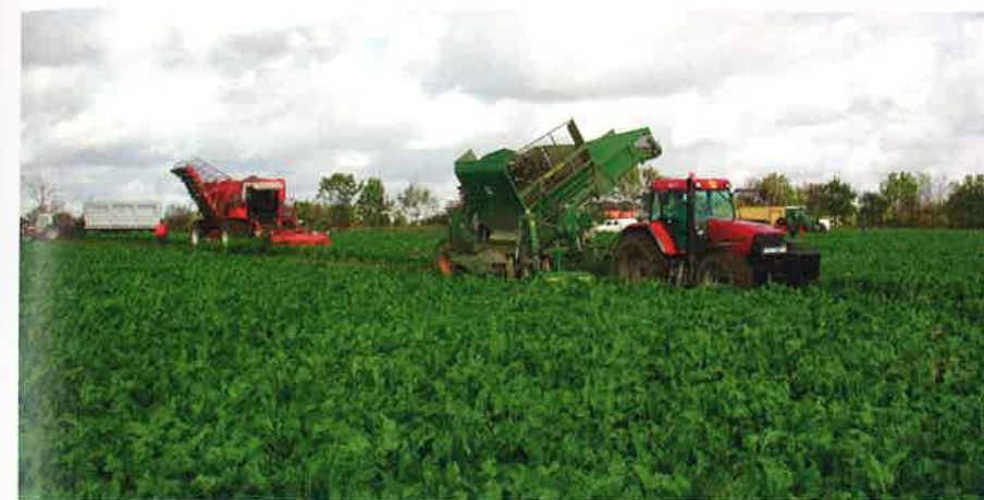
Thyregod och Riecam, ettan och tvåan av de konventionella maskinerna när det gällde att sortera bort sten. Totalekonomin för Riecam blev dock bättre än för Thyregod tack vare bättre jordfrånskiljning.
