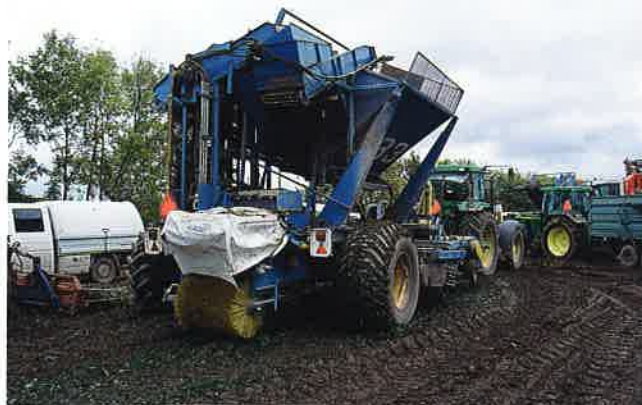
Edenhall 733 utrustad med elektronisk stenfrånskiljning, dold bakom den mot solinstrålning skyddande vita plasten. Borstens uppgift är att återföra eventuella betor som elektroniken av misstag sorterat bort.
