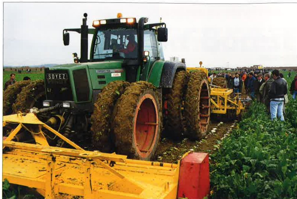
Tolvrådiga JPS blasar, tar upp och lägger på sträng
