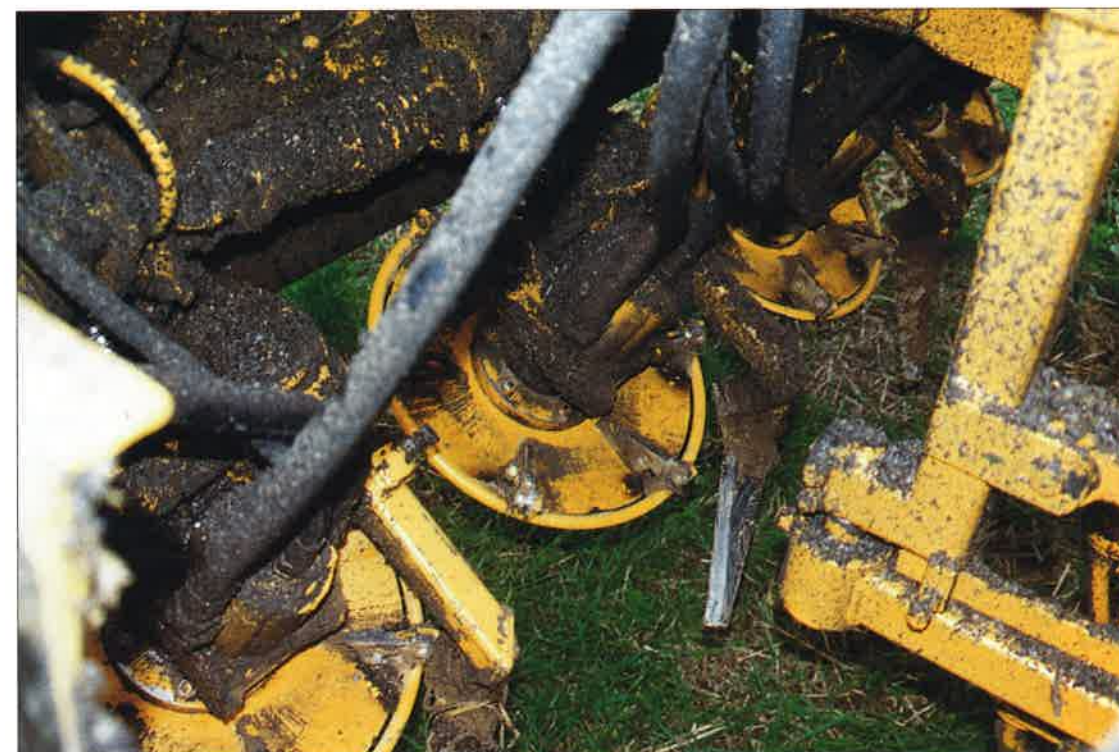
Kleines rotor som både tar bort orenheter från nacken och anvisar nackhöjden för putskniven.
