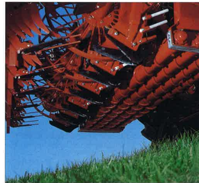
Inmatningsrullarna på Holmers upptagare har ändrats inför kommande säsong.
