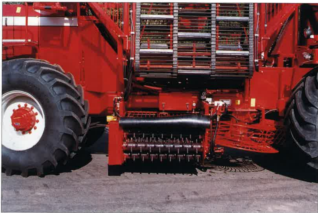
På Verveat finns rullrensverk med inbyggd reverserande rulle.
