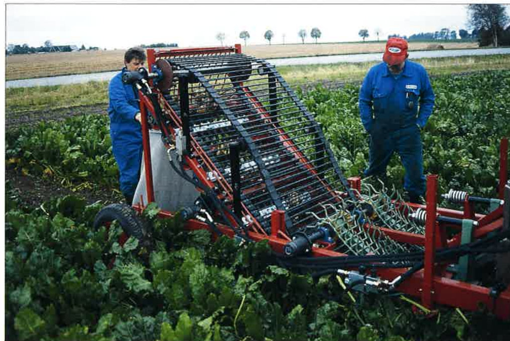
Resultatet av en säsongs arbete skördas med en specialkonstruerad betupptagare som samlar betorna rutvis i säckar. I varje försök representeras en behandling av fyra säckar. Totalt skördades 2 700 rutor (d v s lika många säckar) i Samarbetskommitténs försök 1996.
