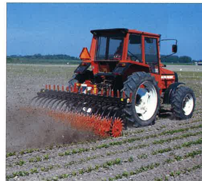
Rullharvning av sockerbetor. Rullharven skall köras fort, minst 15 km/h, för att ge tillräcklig ogräseffekt.
