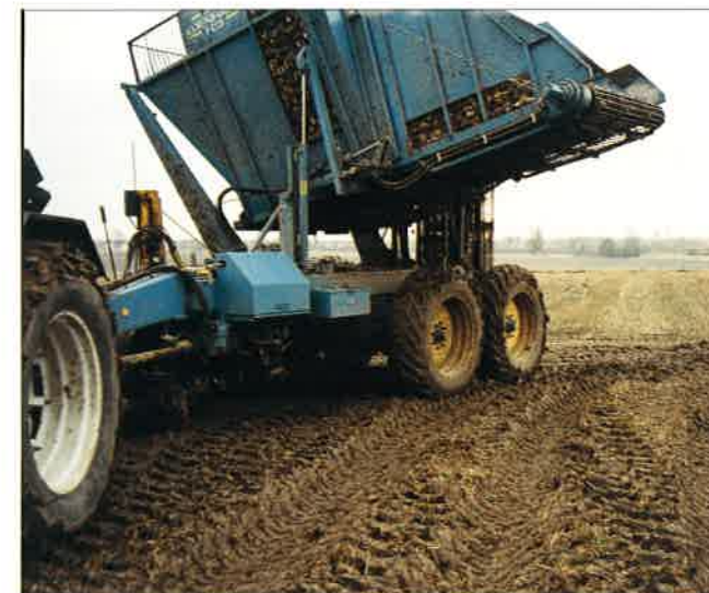
Packning av försöksparcell med treradig tankmaskin.
