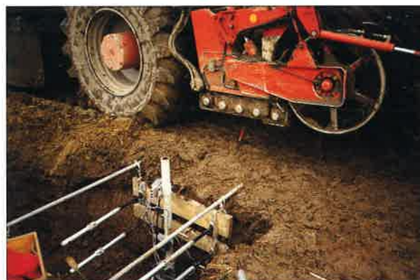
Mätning av jordrörelse vid packning. En plexiglasscylinder innehållande en vätska monteras horisontellt i marken från en grävd grop. Vätskan är förbunden genom en slang med en trycksensor i gropen. Rörelser i marken vid en överfart registreras som en tryckförändring av trycksensorn.
