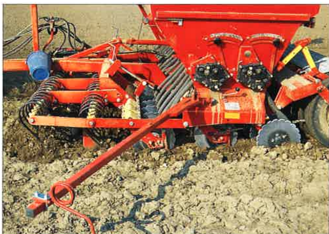
Den dubbla Crossboard-plankan bearbetar jorden bra men är effektkrävande. Skivbillarna smyger effektivt ner gödseln i fuktig jord utan att flisa upp rå jord
