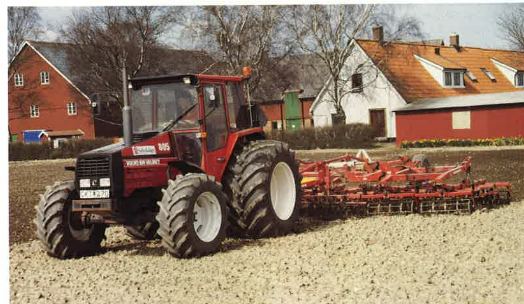
Jordbearbetningen utföres med en körning med för fältet anpassat redskap. Ordentlig däckutrustning medger körning med högst 0,3 kg tryck.
