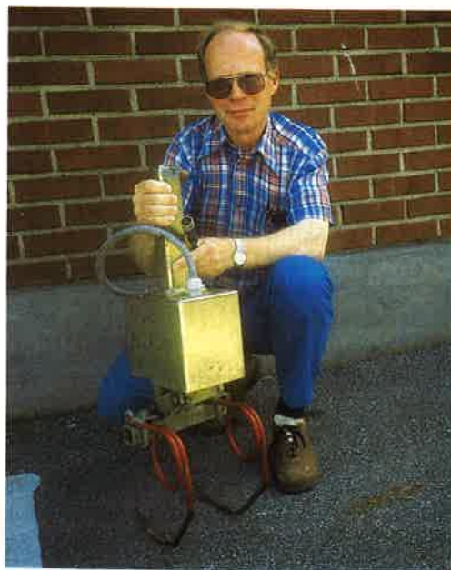
Satsa på automatisk djup- och sidoreglering! Här visar Nils-Åke Nilsson på SSA Maskinteknik utrustning som enkelt kan monteras in även på äldre betupptagare.
