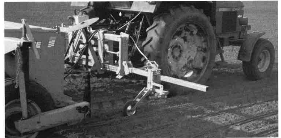
Styrram för exakt sidostyrning, som kan användas till flera redskap utan någon omställning.
