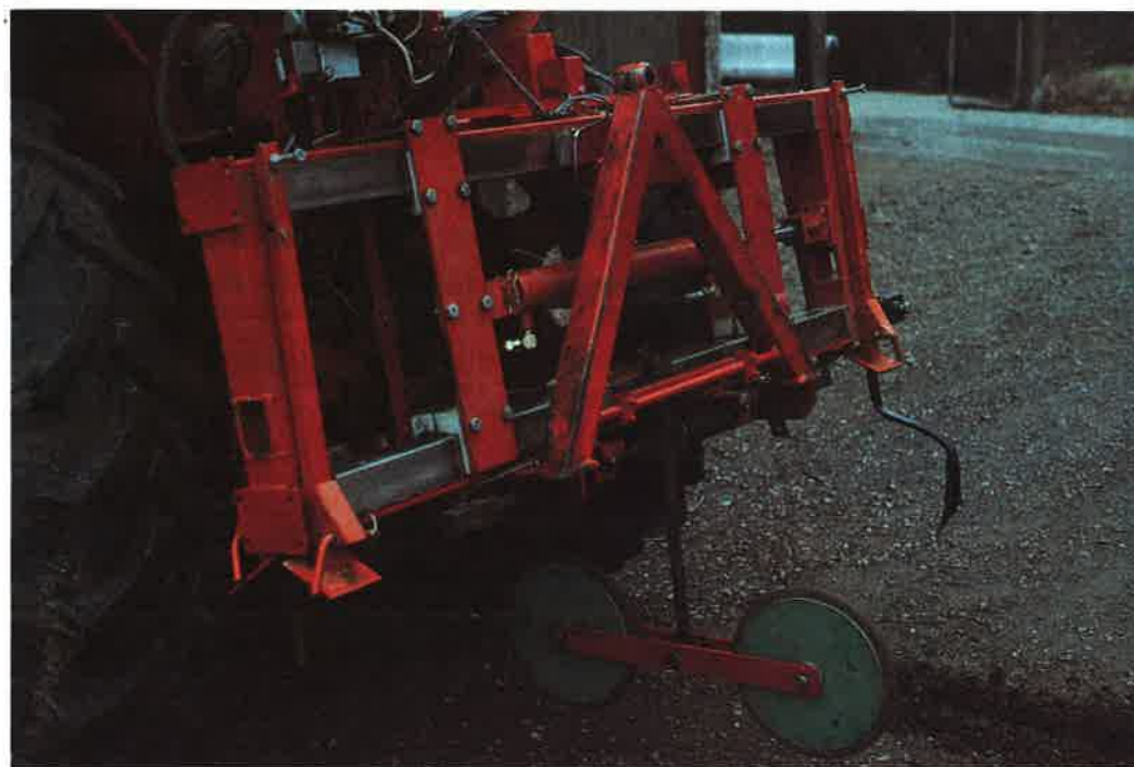
Styrarm för exakt sidostyrning av t ex radrensare
