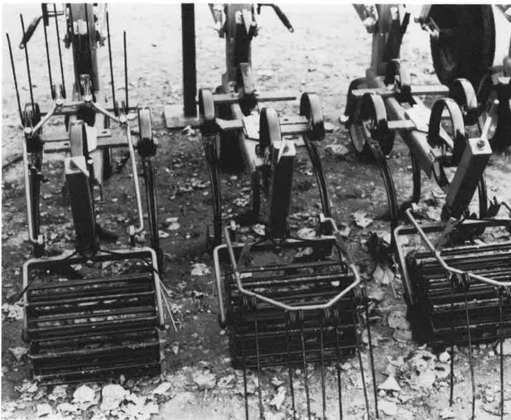
Hacka med skär som går plant och kan ställas nära raden med efterföljande ribbvält som krossar kokor och fjädrande pinnar som jämnar och lägger ogräsen på ytan.
