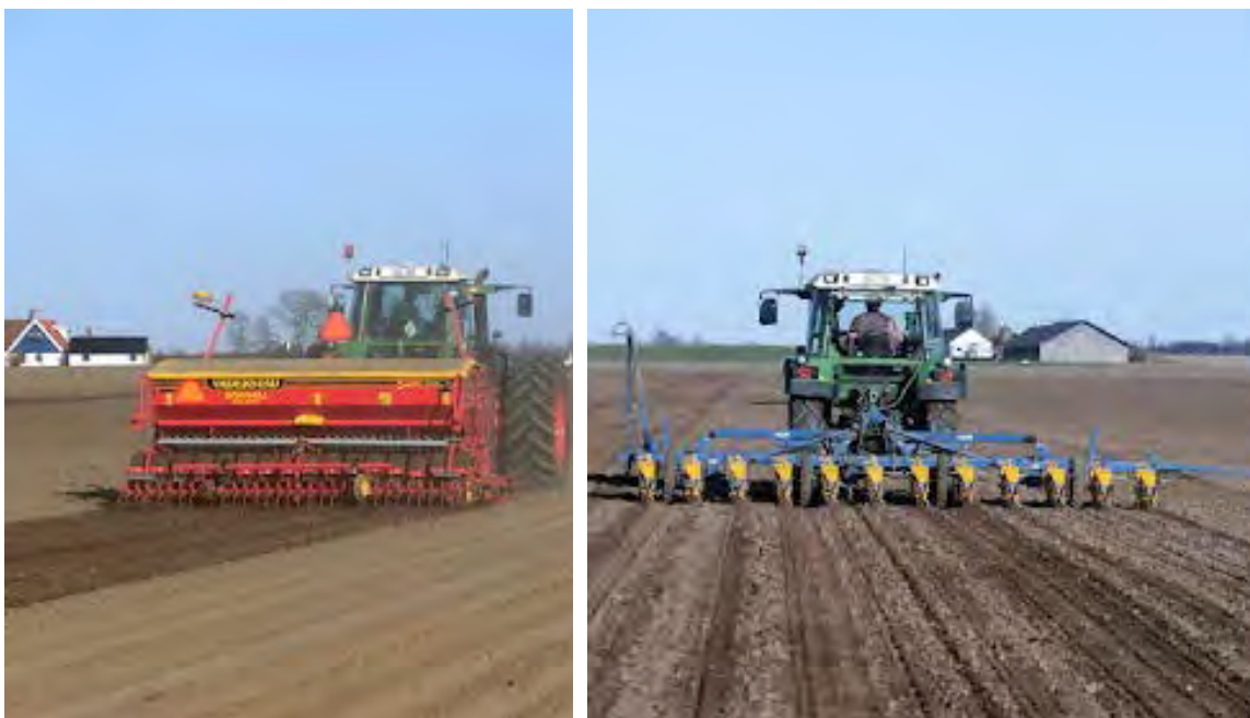
Figur 7. Granhills egen etableringsmetod där vårplöjning med tiltpackare följdes av djupmyllning med Väderstad Rapid och därefter betsådd.
