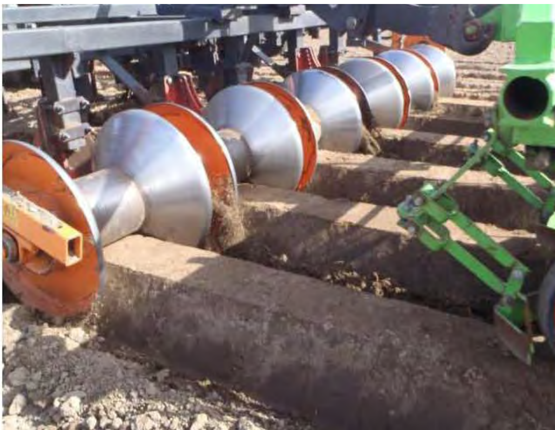
Figur 6. Kamformare som kuper jorden till ca 20 cm höjd.
